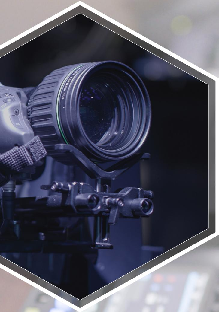
Les quatre caméras du plateau sont montées sur robotisation et sont toutes pilotées depuis la régie par un unique opérateur.
